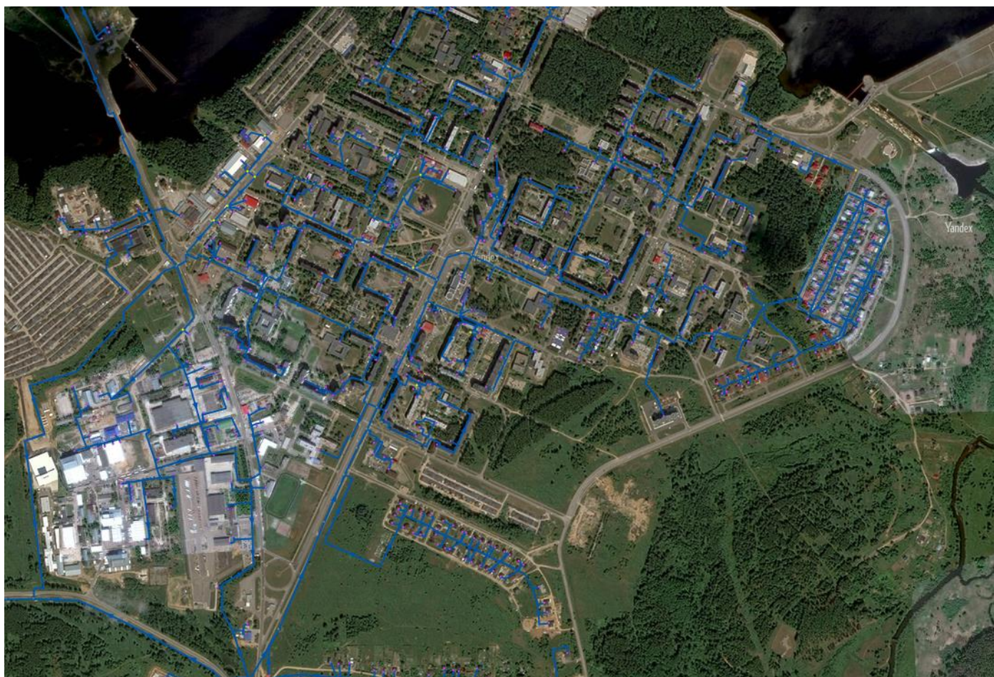
Рисунок 2.4 Система теплоснабжения г. Десногорск на подложке слоя «Спутник»
